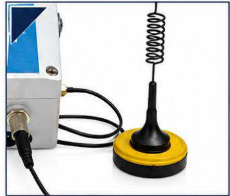
External Antenna Module
